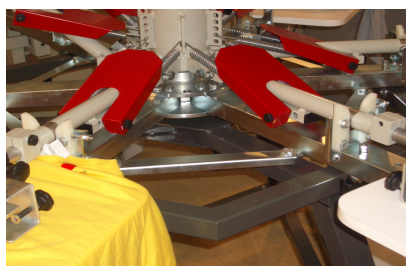
TEXIPRINT i utförande 10/10 med justerbart ramfäste. Bild visar underredskonstruktionen för modell FPKE.
