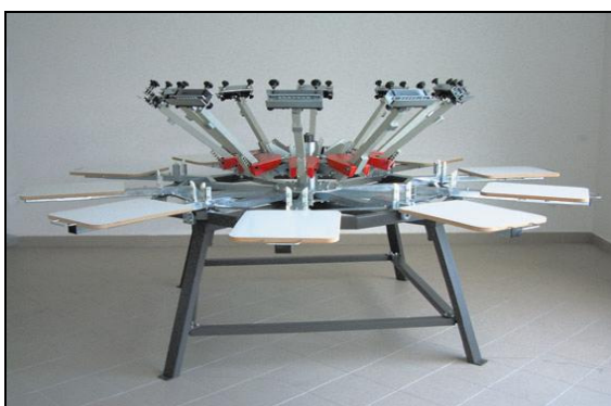
TEXIPRINT i utförande 10/10 med justerbart ramfäste. Bild visar underredskonstruktionen för modell FPKE.
